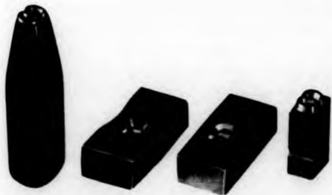
Punzone in acciaio - Matrice punzonata su rame - Matrice rettificata e giustificata - Carattere fuso
