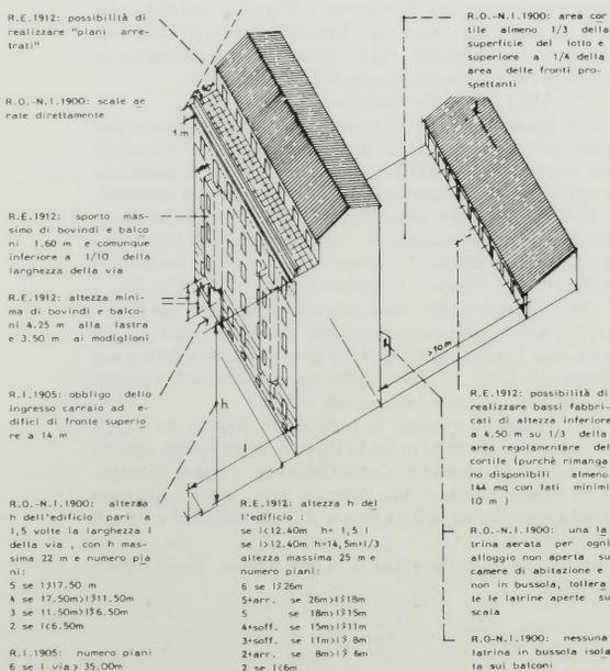
Schema esemplificativo delle norme delle VARIANTI AL REGOLAMENTO EDILIZIO 1921-22, del REGOLAMENTO DI IGIENE 1926 e sue VARIANTI 1927-28-29-30-31
