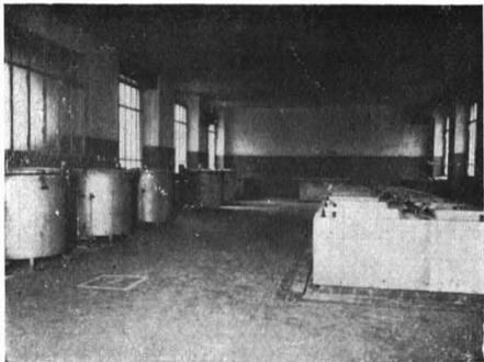
Sala delle vasche di macero e di lavatura a mano e delle lisciviatrici a vapore.
