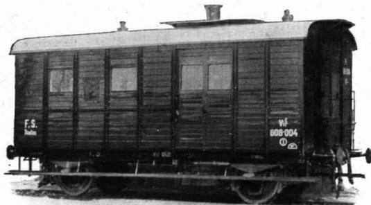
Carro-Caldaia per riscaldamento treni.
