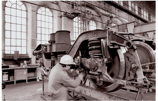
*Lavorazione delle Sala Montata e dei Carrelli: dall'alto, smontaggio del carrello di automotrice, compressione delle molle del carrello, tornitura e lavorazione dell'assale di una Sala Montata, anni '80-'90 (fotografie Pier Paolo Viola)*
